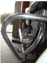
A fixação na estrutura do veículo tem que obedecer às especificações do fabricante e não pode interferir no movimento do pára-lama dianteiro.
