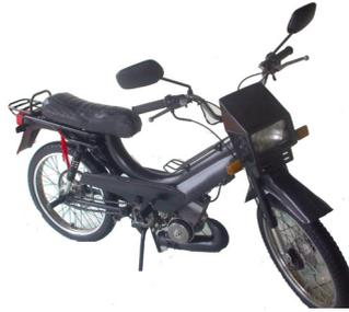
Veículo de duas rodas, com motor de até 50 cc e velocidade máxima de 50 km/h.
