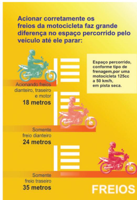
O tempo de frenagem depende do atrito entre os pneus e o solo. A frenagem mais eficiente é a que o motociclista aciona ao mesmo tempo os freios traseiro e dianteiro, deixando para acionar a embreagem no último instante da frenagem, usando assim a força do motor para reforçar a parada da moto (freio motor). Quando se utiliza a embreagem juntamente com os freios, a roda fica livre e sobrecarrega os freios.
