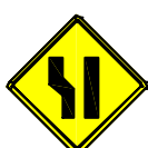
A-21 d Alargamento de Pista à Esquerda
