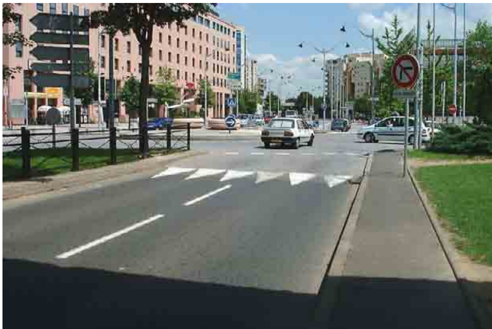
Photo 4 : Ce type d'équipement qui privilégie une incitation « visuelle » (chaussée étroite, pavés et signalisation au sol) à une contrainte matérielle est nettement plus sécurisant pour les conducteurs de deux-roues motorisés.
