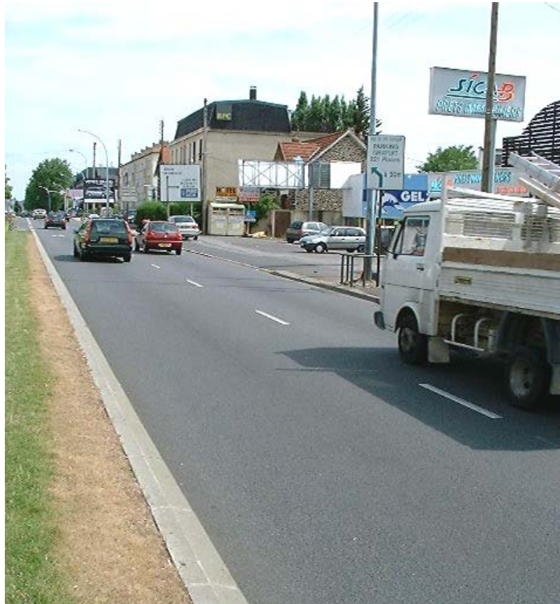
Photo 16 : L'abondance de panneau de tous types nuit grandement à la compréhension de la route ; de plus, la multitude de supports en décalant représente une source supplémentaire d'insécurité pour un conducteur de deux-roues ayant chuté.
