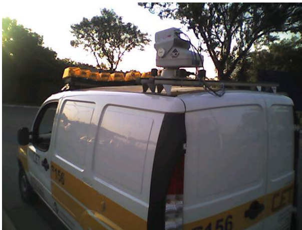
Figura 6 – Veículo com LAP embarcado para a fiscalização do Rodízio Municipal
